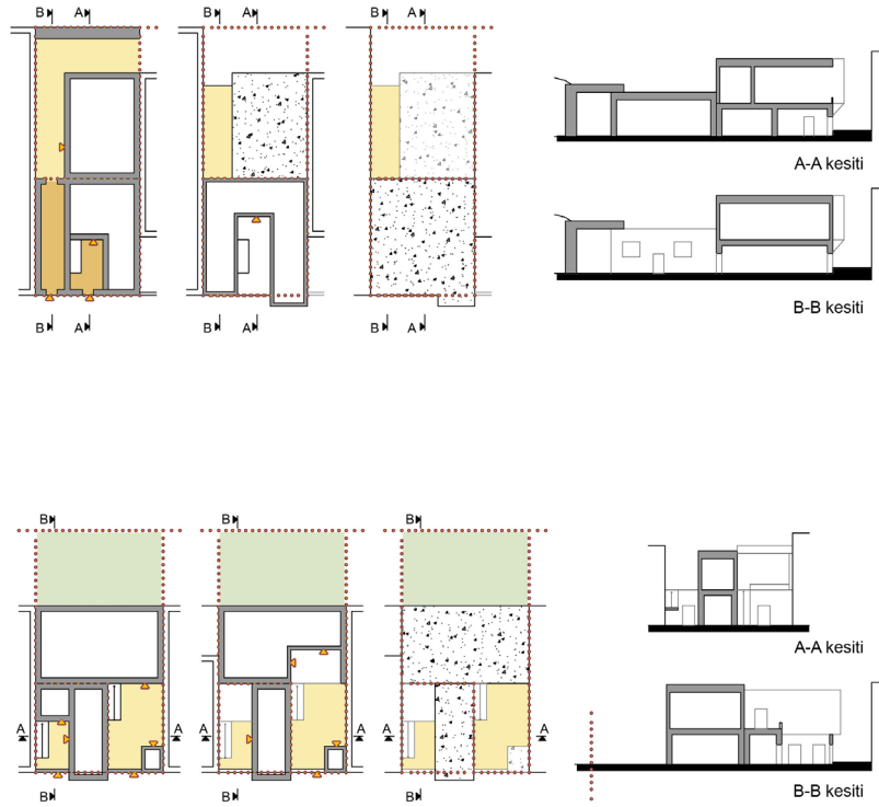
Şekil 5. Kayseri Mancusun (Yeşilyurt) yerleşimi: parsel/konut tipolojisi ve morfolojisi; yamaç yerleşimi Tip 1 (üst) ve düzlük yerleşimi Tip 2 (alt) olarak sınıflanmıştır.
