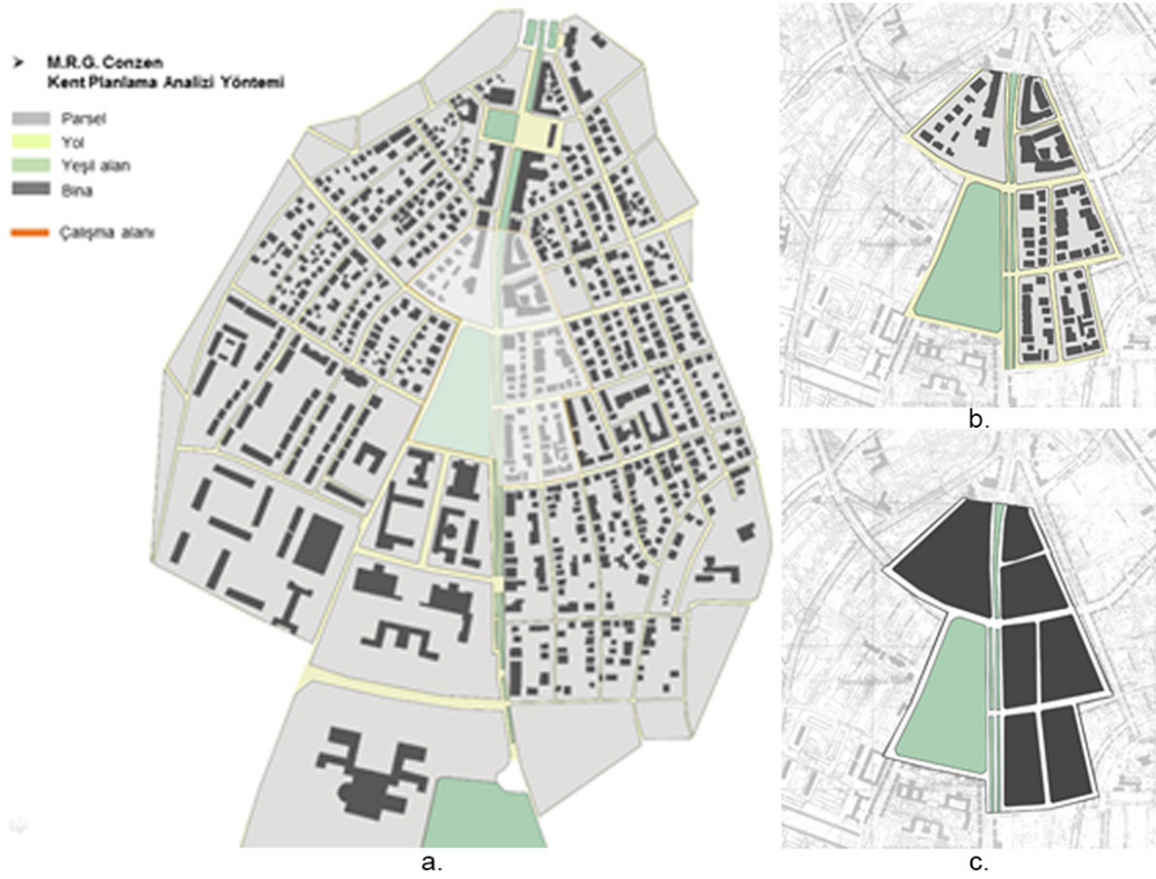
Şekil 12. Makro ölçekte incelenen Yücel-Uybadın Planı. a. Çalışma alanı ve çevresinin makro ölçekte parsel, yol, yeşil alan, bina öğelerinin analiz edilmesi, b. Çalışma alanı sınırları içerisindeki parsel, yol, bina ve yeşil alan analizi, c. Çalışma alanı sınırları içerisindeki parsel, yol ve yeşil alan analizi (ODTÜ ŞBP Arşivi'nden elde edilen veriler ile yazar tarafından üretilmiştir.)
